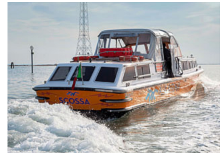
Angetrieben wird die Scossa durch einen elektrischen Hauptmotor, der von Batterien mit Strom versorgt wird.
