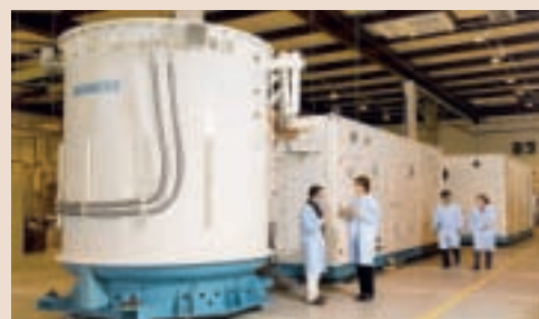
In Kombination mit Gasturbinen erreichen Brennstoffzellen bis zu 70% Wirkungsgrad.
