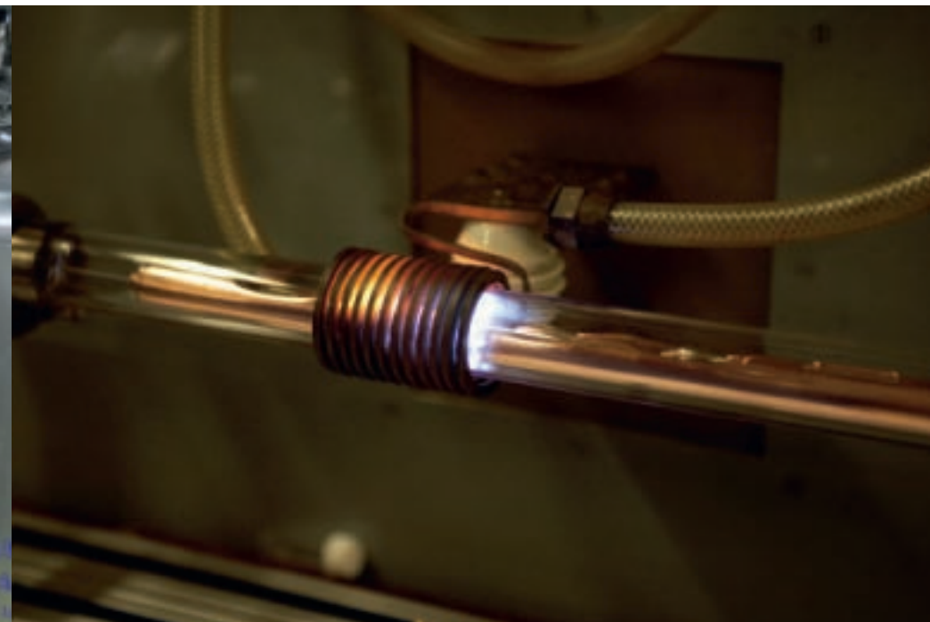
IM INDUKTIONSSCHMELZOFEN werden seltene Erden zu Käfigverbindungen verschmolzen. Ein Ansatz, um Kühlelemente für supraleitende Elektronik zu entwickeln.
