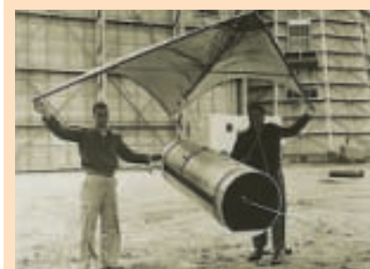
Drachen im Raumfahrteinsatz: Die NASA wollte mit halbstarren Rogallo-Flügeln ausgebrannte Raketentufen sicher zur Erde zurückbringen.
