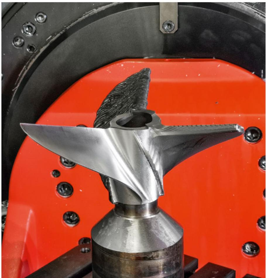
Diese kann man mit einem Laserscan ermitteln. Alternativ kann man auch gleich den digitalen Zwilling des Rohteils aus der Schweißsimulation verwenden.
