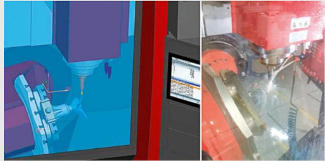
Die Speedboat-Propellerflügel in drei Fertigungsstufen (rechts). Unten: Der digitale Zwilling des Propellers zeigt an, was wegfräst werden muss.
