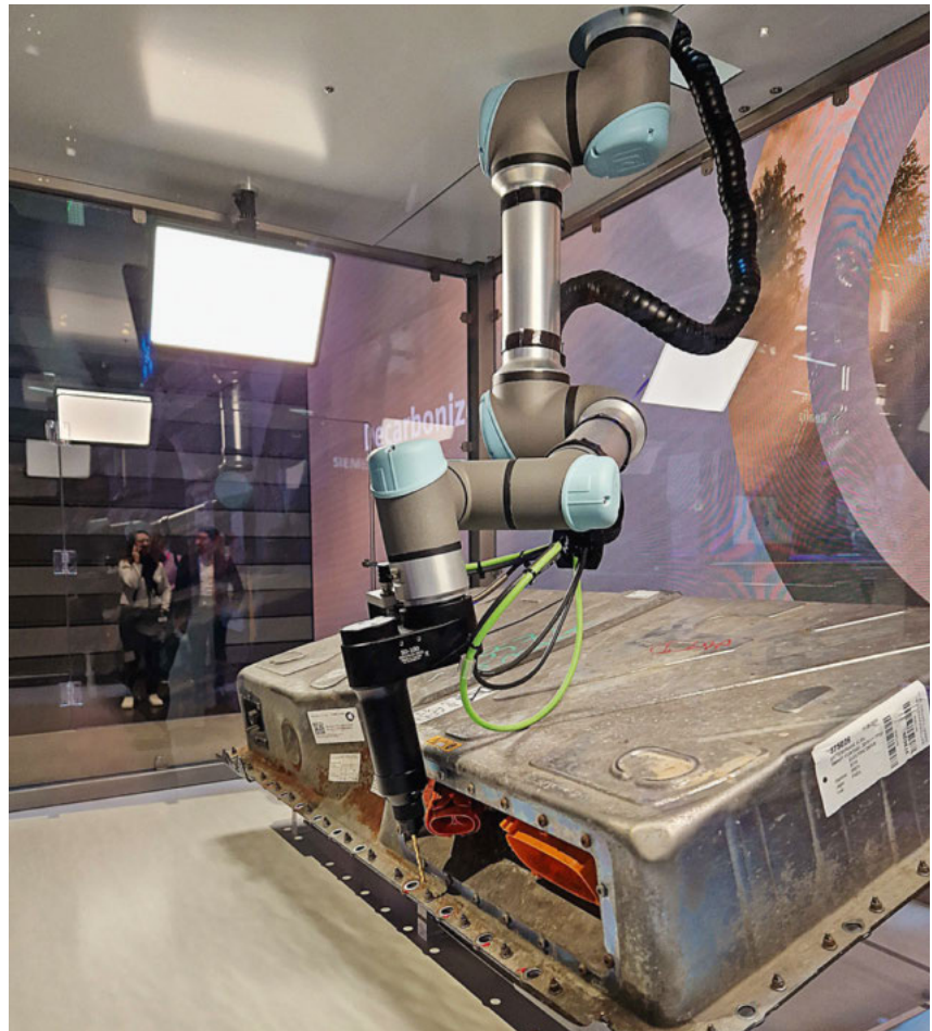
Lithium-Ionen-Batteriepacks sind komplex und bergen Explosionsrisiken: Das AI-Modell erkennt verschiedene Komponenten und unterstützt die sichere Demontage.
