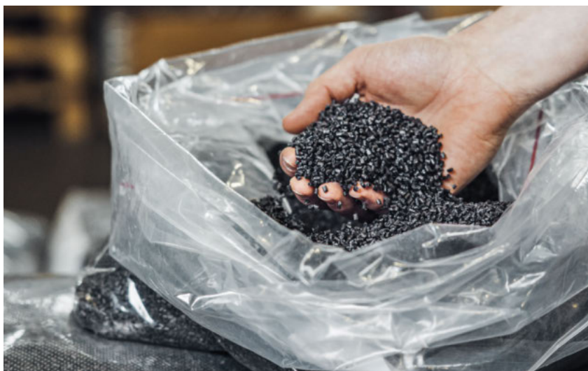
Aus ausgedienten Kohlenstofffaserprodukten oder -abfällen entsteht Recyclingmaterial für die Verwendung im 3D-Druck oder im Spritzguss.
